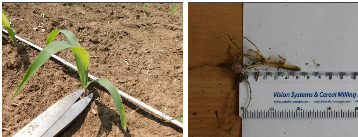
8. ábra: A munkamélység mérése
