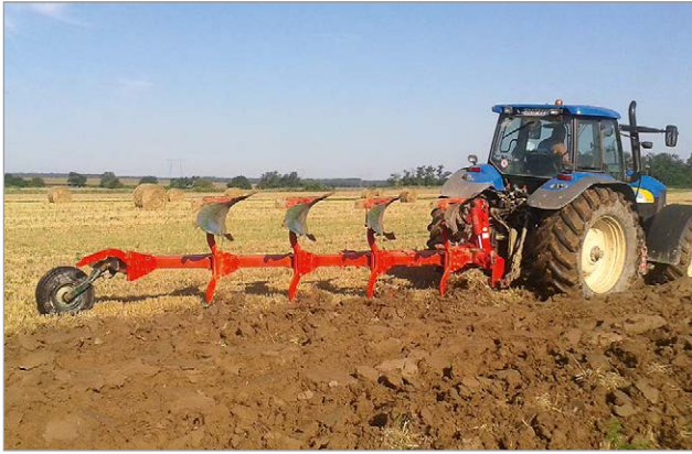
3. ábra Vogel&amp;Noot ©plus XM négytestű váltva forgató eke
