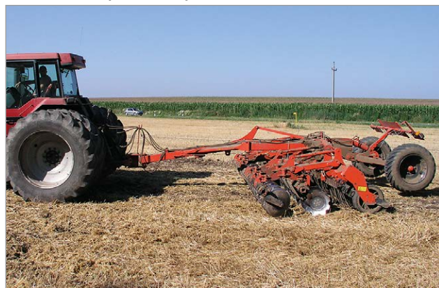
2. ábra Kuhn Optimer kompakt tárcsás borona
