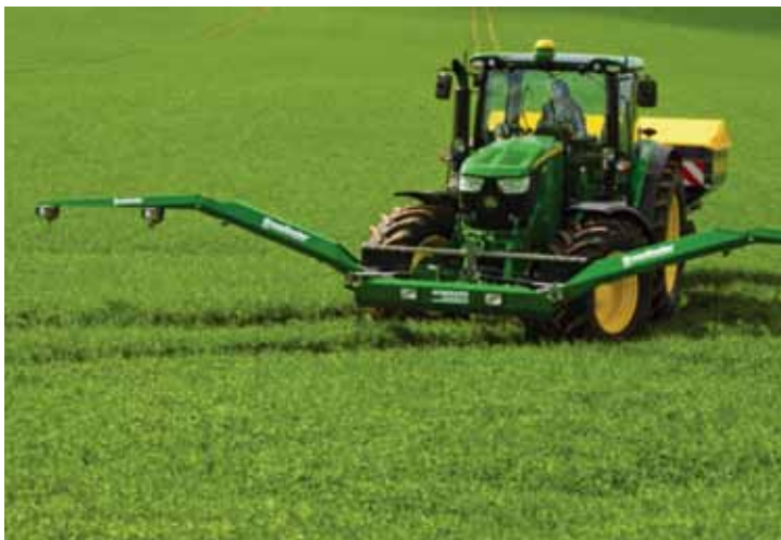
Traktorra szerelhető zöld tömeg és N-ellátottság érzékelő berendezés. Applikációs NDVI térkép készítéséhez adatgyűjtésre és műtrágya szóró vezérlésére használatos
