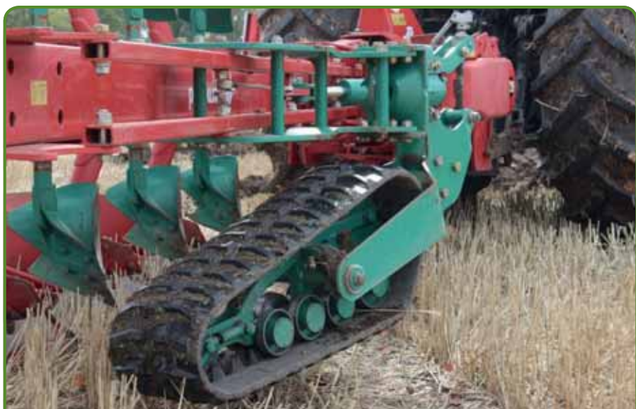
4. kép A Kverneland 2500 eke talajkímélő mélységhatároló kereke
