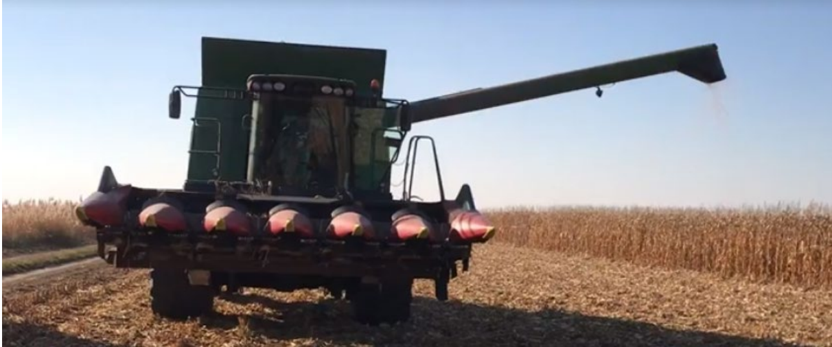
3. ábra: A kombájn tartályának ellenőrzése a kihordó csiga legalább 30 mp-es járatásával történik.
